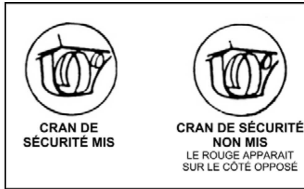
Figure 2 Vue détaillée du cran de sécurité
