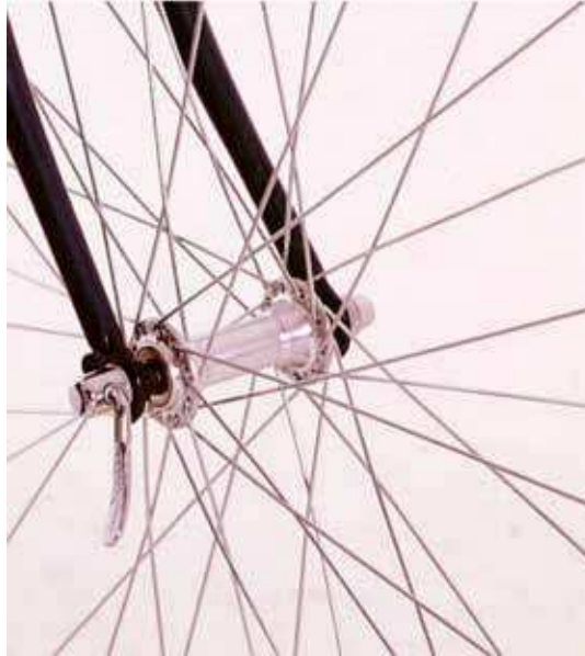
Figure 16-3-7 Position incorrecte du levier de déclenchement rapide – Exemple 1
