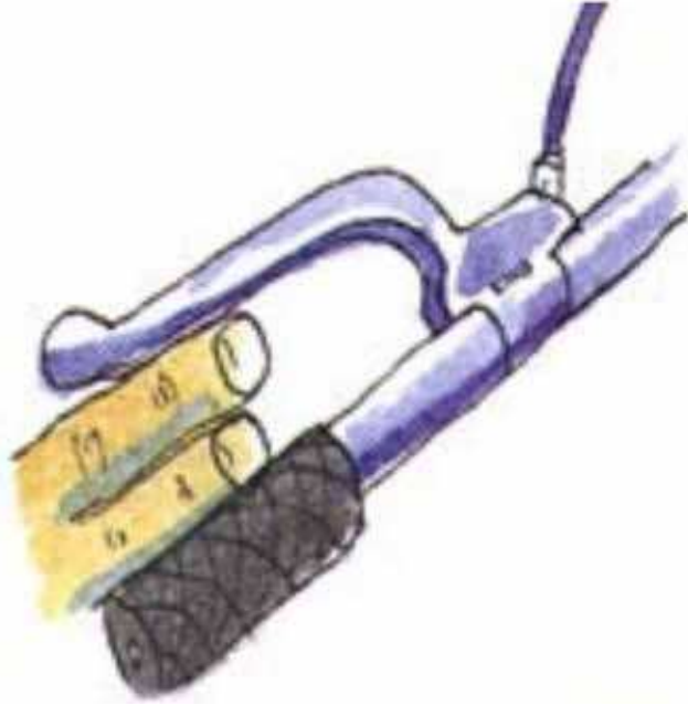
Figure 16-3-5 Positionnement de la manette de frein
