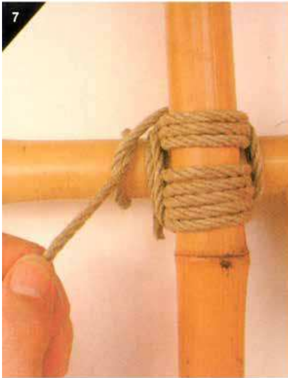
ÉTAPE SEPT. FAIRE UNE DEMI-CLÉ À CAPELER AUTOUR DE LA PERCHE HORIZONTALE.
