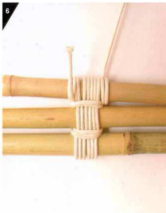
ÉTAPE SIX. FAIRE UNE DEMI-CLÉ À CAPELER AUTOUR DE LA PERCHE QUI A DÉJÀ UNE DEMI-CLÉ À CAPELER (DU DÉPART) À L'EXTRÉMITÉ OPPOSÉE.
