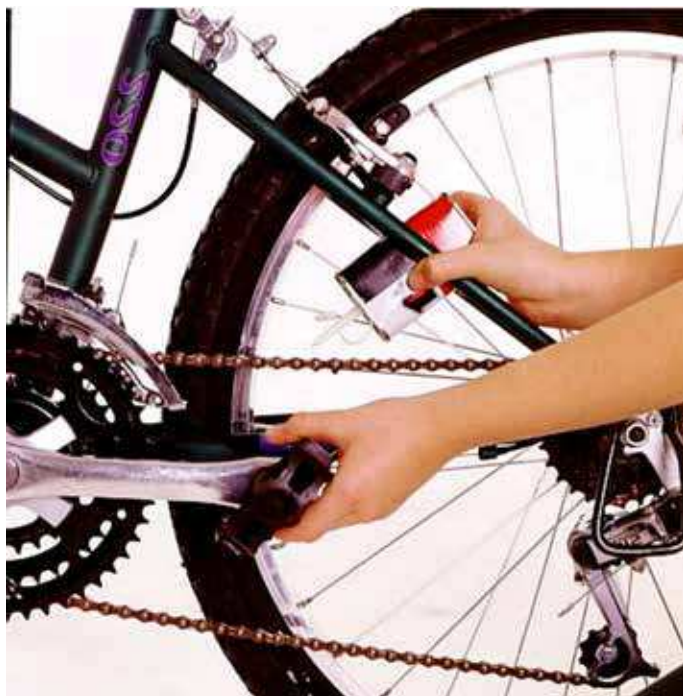
Figure 16-3-6 Lubrification de la chaîne
