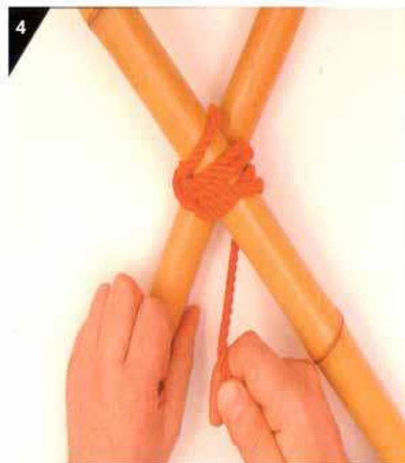
ÉTAPE QUATRE. CHANGER DE DIRECTION EN PASSANT AUTOUR DE L'UNE DES PERCHES.
