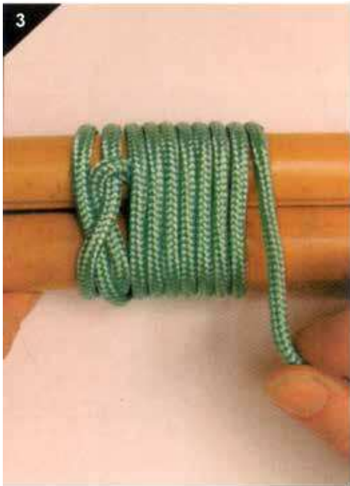
ÉTAPE TROIS. FAIRE HUIT À DIX ENROULEMENTS DE PLUS AUTOUR DES PERCHES.
