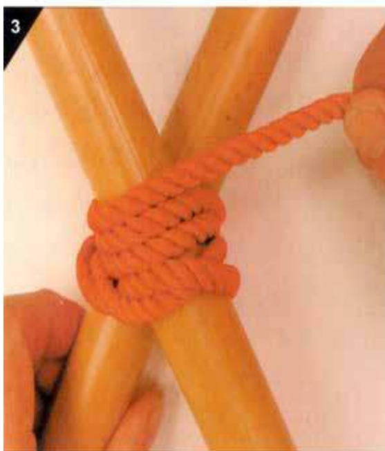
ÉTAPE TROIS. FAIRE TROIS TOURS COMPLETS DE PLUS DANS LA MÊME DIRECTION, EN LES SERRANT.
